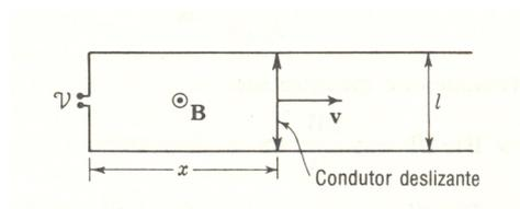
**Figura 8.4.3** Condutor deslizante para aumentar a área da espira (Obs.: na figura  $v \equiv \mathcal{E}$ ).
