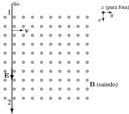
**Figura 8.4.1** Uma FEM é induzida num fio que se move através de um campo magnético.
