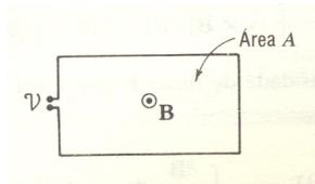
**Figura 8.4.2** Espira fixa de área  $A$  (Obs.: na figura  $v \equiv \mathcal{E}$ ).
