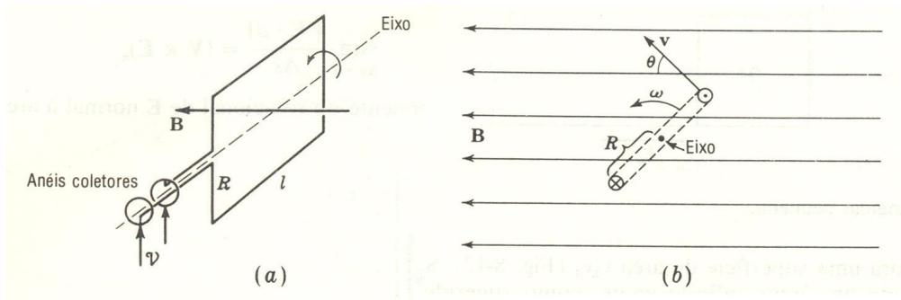
**Figura 8.4.5** Gerador de C.A.: (a) vista em perspectiva; (b) seção transversal perpendicular ao eixo. (para os exercícios 6 e 7. Obs.: na figura  $v \equiv \mathcal{E}$ )
